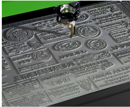
Grawerowanie i cięcie laserowe pieczętek atramentowych
